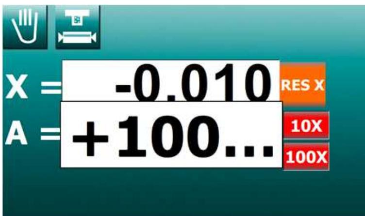
Durch die Einstellung der absoluten Position der Achse **X** ändert sich nicht die Position des Schleifspindelstocks (es ändert sich nur die Anzeige).
