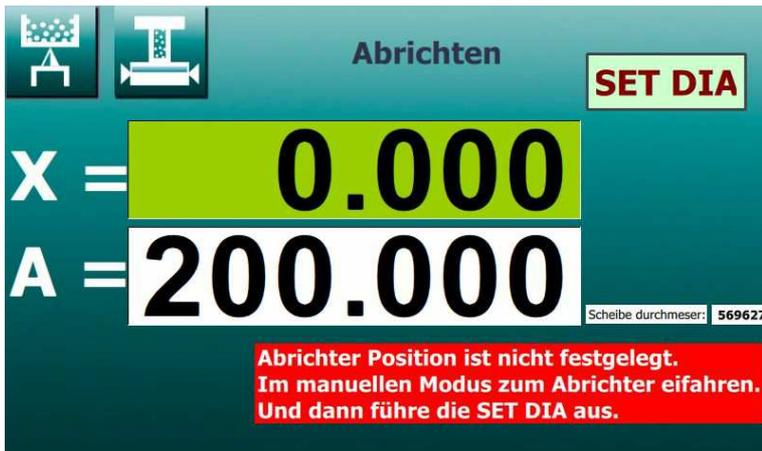
Man drückt die Taste **F7**
