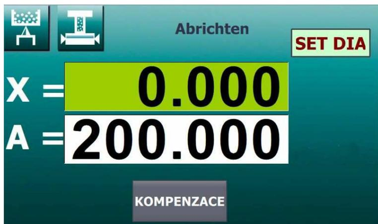
Mit der Taste auf dem Maschinenpult wird die automatische Tischbewegung mit der im Vorfeld gewählten Abrichtgeschwindigkeit eingeschaltet. Mit dem Handrad wird die Schleifscheibe nach vorne um das Abrichtinkrement umgestellt und die Schleifscheibe wird abgerichtet. Nach dem Abschluss des Abrichtvorgangs wird die Taste **KOMPENSATION** gedrückt, Damit wird die Position der Scheibe um die Größe des Abrichtens kompensiert.
