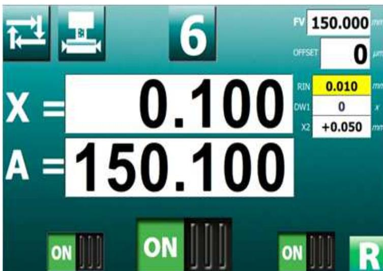
Nach der Umschaltung in den automatischen Betrieb mit der Taste **F2** drückt man die Taste **F8**. Der Schleifspindelstock wird in die Ausgangsposition für das Schleifen versetzt. Mit dem Handhebel wird der Schleifvorgang gestartet. Beim Schleifen kann man mit den Tasten links und rechts unten die Zugabe in Wendepunkten ausschalten. Die Zustellung kann man jederzeit durch das
